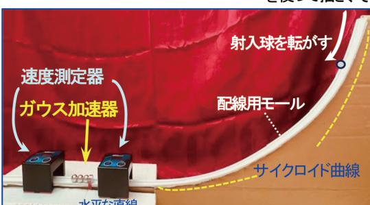
**実験 1** 装置を固定せず、射入球を様々な速度でガウス加速器に衝突させた。射入球と発射球の速度、装置のずれを50回測定した。
